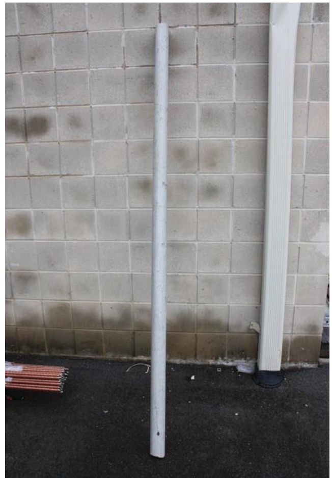
2.5 Inch Schedule 40 Conduit
